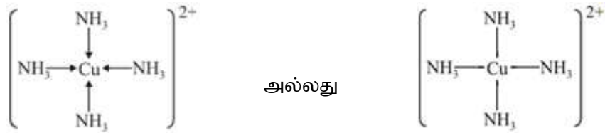
உரு 2.7 \text{Cu}^{2+} - அமோனியா சிக்கலில் ஈதற்பங்கீட்டுப்பிணைப்பு [\text{Cu}(\text{NH}_3)_4]^{2+} சிக்கல்
